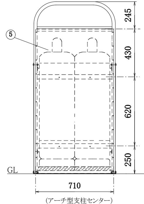
※ 震度7(818gal程度)の強い地震でもガスボンベを転倒させない為に必ずボンベチェーンは上下2本懸けとして下さい。
